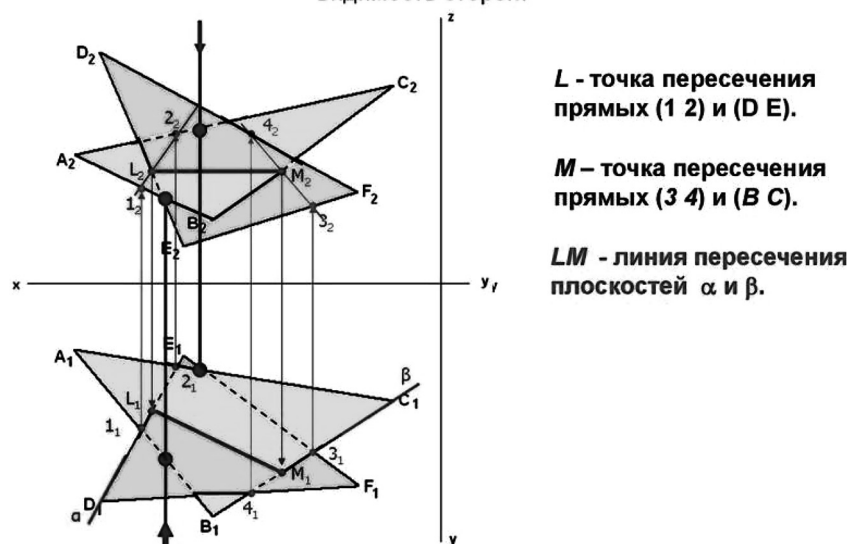
Рис.1. Построение графического задания пересечения поверхностей [12].
