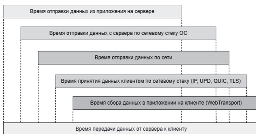
Рис. 2. Схема пересечения временных интервалов при передаче данных с использованием стека QUIC|TLSv1.3|HTTP/3|WebTransport
