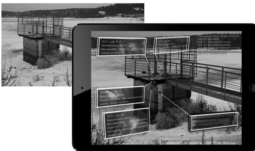
Рис. 2. Пример возможного использования результатов цифрового проектирования и технологии дополненной реальности\* при приемке ремонтных работ гидроузла (\*технология для применения на практике аттестованными специалистами, в учебных целях, увы, это пока недоступно)
