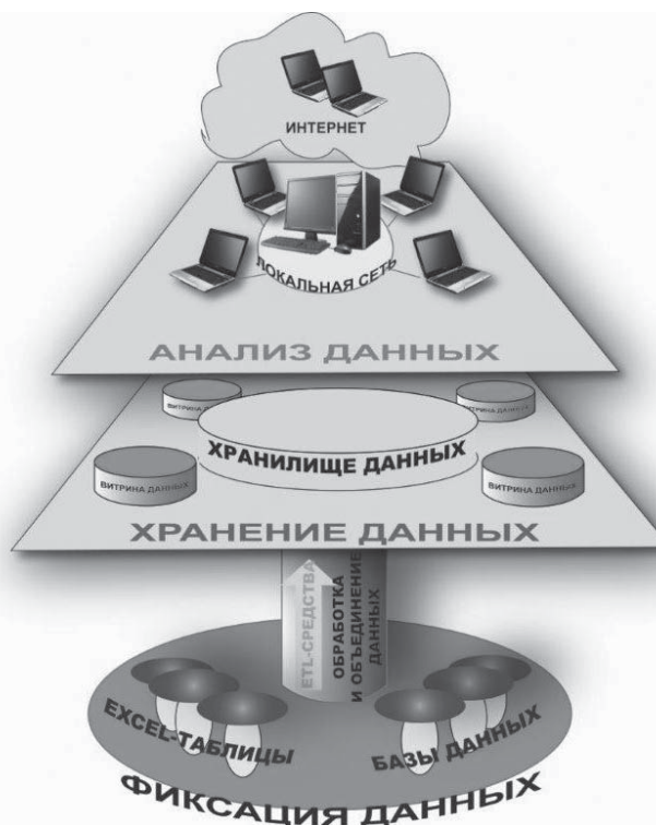
Рис. 1. Архитектура информационно-аналитической системы
