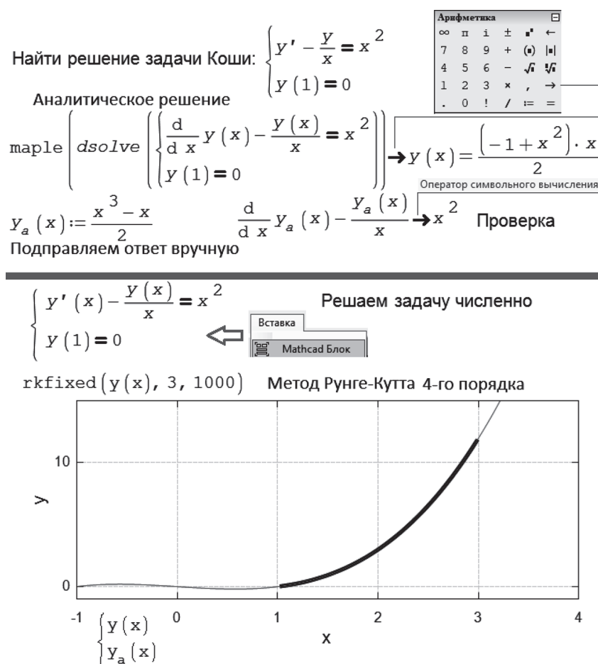
Рис. 3. Решение задачи Коши на компьютере Fig. 3. Solving the Cauchy problem on a computer
