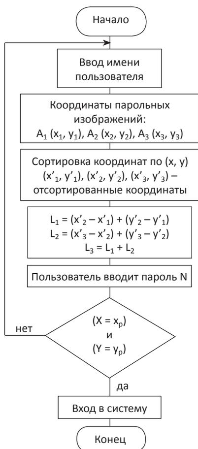
Рис. 6. Схема аутентификации методом «модуль координат»
