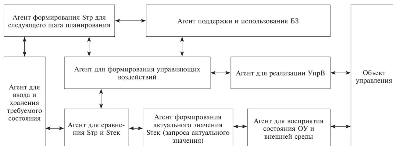
Рис. 1. Киберфизическая система с возможностью адаптации
