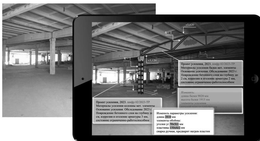
Рис. 6. Пример возможного использования результатов цифрового проектирования и технологии дополненной реальности* при усилении конструкций (*технология для применения на практике аттестованными специалистами)
