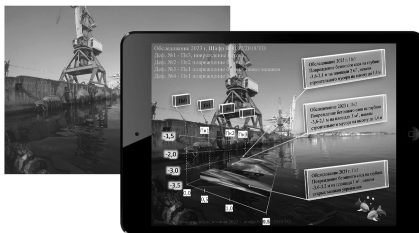
Рис. 4. Пример возможного использования результатов цифрового проектирования и технологии дополненной реальности* при последующем обследовании пирса (*технология для применения на практике аттестованными специалистами)
