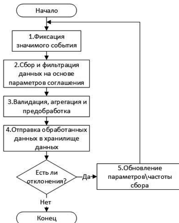
Рис. 1. Алгоритм микросервисной реализации сбора данных Fig. 1. Algorithm of microservice implementation of data collection
